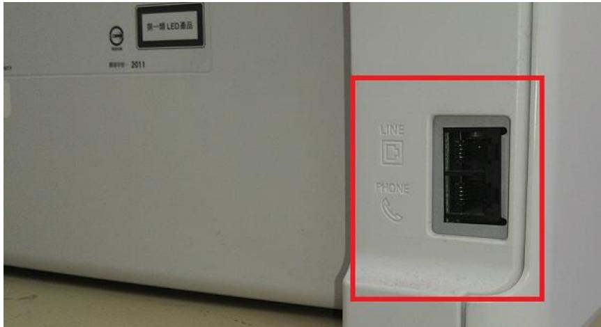
步驟 2、確認傳真的電話線接在上方的「LINE(進線)」孔位上。
